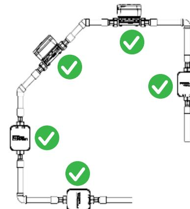
Fig. 1.4. positions d'installation possibles
